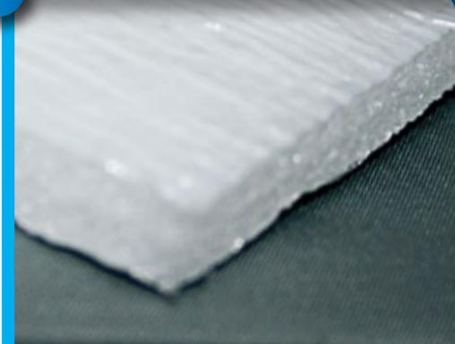
Espuma de polietileno de celda cerrada en espesores de 10, 5 y 3mm laminado con aluminio puro de un lado y un film de poliéster blanco.
